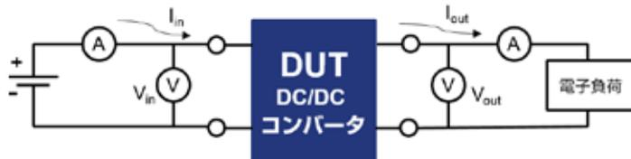
図1. DC - DCコンバーターの接続
